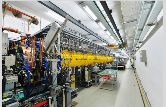
2016年1月,漂移管直线加速器第一段加速腔(DTL-1)调束完成,负氢离子束流成功加速到设计能量21.6MeV,峰值流强达到18mA,在束流流强测量误差范围内,束流通过率为100%。DTL-1束流调试成功,是CSNS工程建设的又一个重要里程碑。
